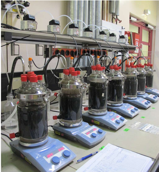
Abbildung 1: Anordnung von sieben 1l-Batch-Reaktoren zur Untersuchung eines Inokulums
