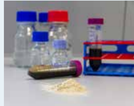
oben: Aus Abwasser zurückgewonnenes Struvit kann als langsam N und P freisetzender Dünger eingesetzt werden
