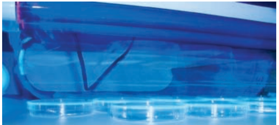
Bild 2: Blick auf einen Teilbereich des Teststandes zur biologischen Prüfung photokatalytischer Oberflächen mit verschiedenen Mikroorganismenstämmen.
