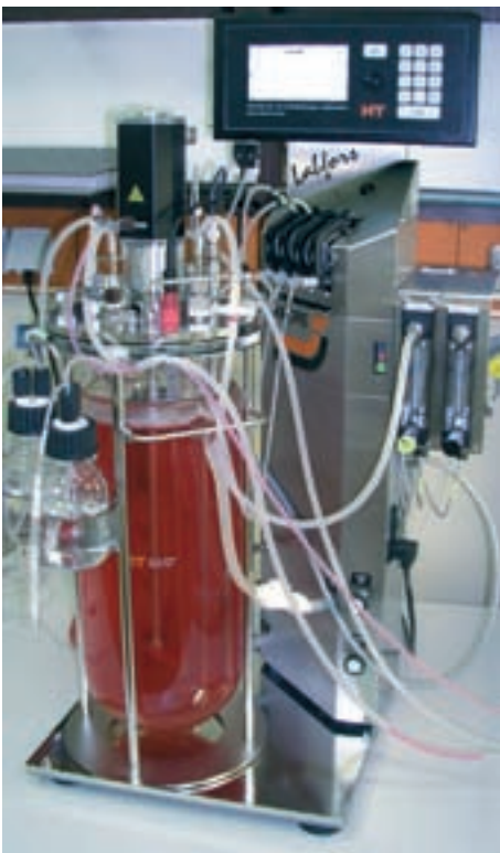
Bild 2: Produktion der neuen Interferon- \beta -Variante (Soluferon ® ) im 10-Liter-Fermenter.
