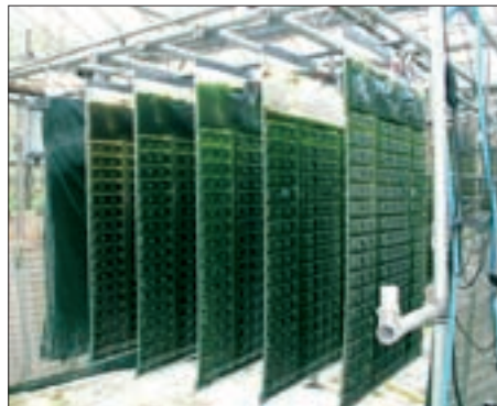
Bild 2: Semikontinuierliches Wachstum von Haematococcus pluvialis im Flachplatten-Airlift-Photobioreaktor (33-Liter-Modul, 1. Stufe: Biomasseproduktion). Über den Abstand zwischen den gemeinsam betriebenen Reaktoren wird die Lichtmenge, die den Algen zur Verfügung steht, kontrolliert.
