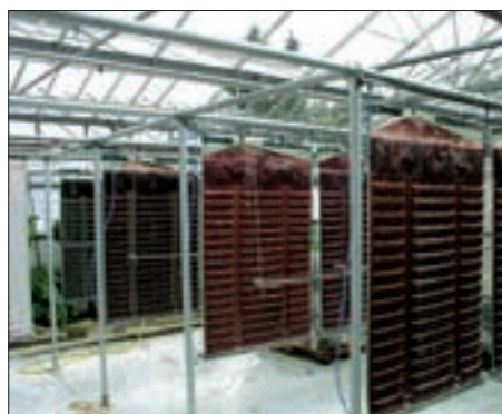
Bild 3: Pilotanlage in einem Gewächshaus zur Produktion von Astaxanthin mit der Mikroalge Haematococcus pluvialis (2. Stufe: Astaxanthinproduktion).
