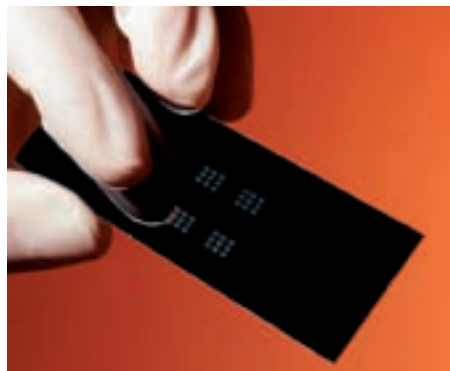
Bild 2: Nanopartikel-Mikroarray auf einem Siliziumchip.
