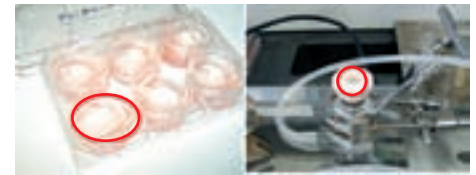
Bild 2: In-vitro -Hautmodell für Untersuchungen der Penetration. Eingesetzt werden dazu so genannte Franzellen, Diffusionszellen für Permeations- und Penetrationsstudien.
