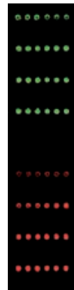
Bild 3: Fluoreszenz-Scan eines Nanopartikel-Mikroarrays nach Inkubation mit fluoreszenzmarkierten Analyten (Antikörper). Die Analytsignale nehmen jeweils von oben nach unten zu, da in dieser Richtung eine zunehmende Dichte an Bindestellen im 3-D-Chip bereitgestellt wird. Jede Reihe zeigt Replika der Assays.
