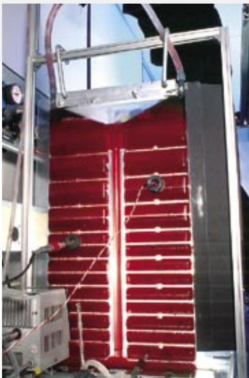
Neuartiger Photobioreaktor zur Kultivierung von Mikroalgen. Durch gezielte Strömungsführung werden die Algen optimal mit Licht versorgt.
