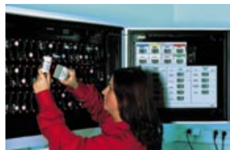
Bild 2: Flüssigkultur-Brutschrank mit Fluoreszenz-Detektionssystem (Bactec 9210) zur automatisierten Sterilitätsprüfung.
