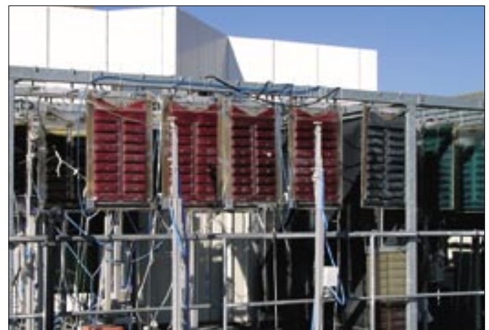
Bild 4: Freiland-Produktionsanlage mit zehn FPA-Reaktoren auf dem Institutsgelände in Stuttgart.
