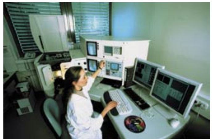
Bild 1: Sortierung und Separation spezifischer Zellpopulationen aus Geweben und Organen über ein FACS-Vantage.
