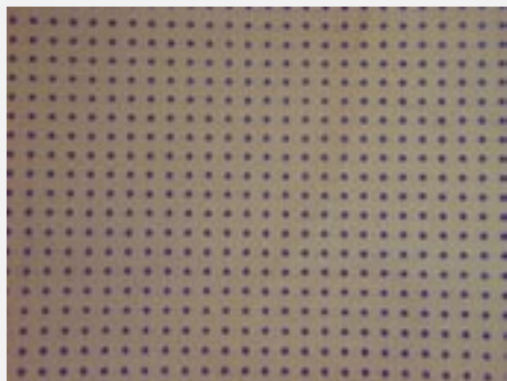
Bild 1: Mikrostrukturierte, punktwise mit Carboxylgruppen ausgerüstete Oberfläche.
