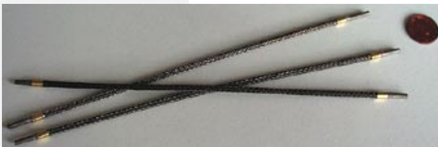
Einzelne Kapillar-Brennstoffzellen, die zu Modulen zusammengesetzt werden können.
