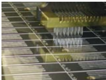
Bild 1: Für die Herstellung von Microarrays werden die Gensonden mit Kapillarnadeln im hochdichten Raster auf festen Trägern positioniert.
